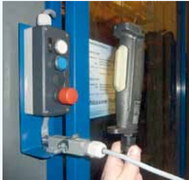
Das Bedienelement mit dem steckbaren Handscharter
